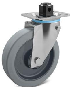
**LENKROLLE MIT ANSCHRAUBPLATTE UND ZENTRALFESTSTELLER ÜBER SCHALTNOCKE**
